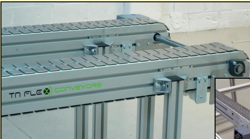
Doble hilera con motor común y eje motriz recto o inclinado
