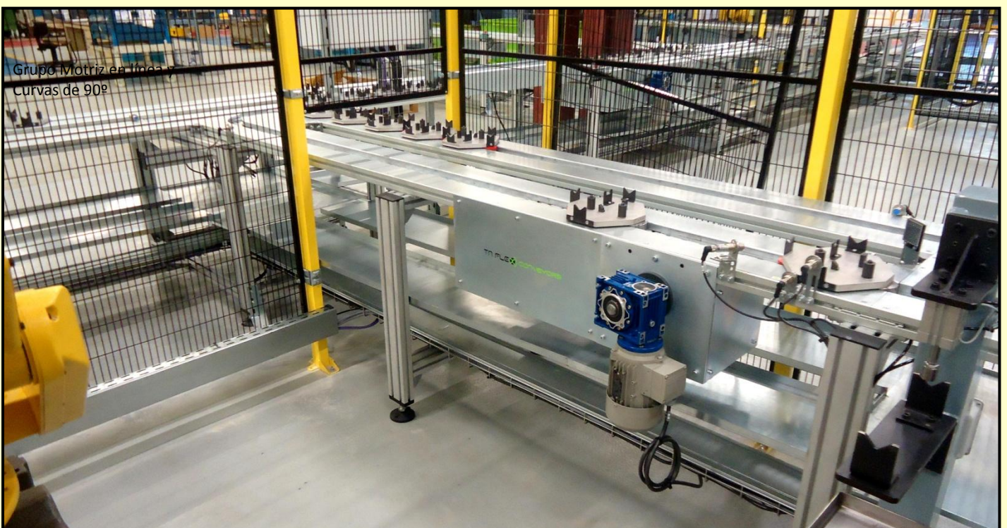
Transportador para carga automática de discos en centro de mecanizado
