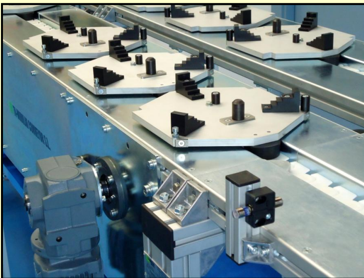
Transportador para carga automática de discos en centro de mecanizado
