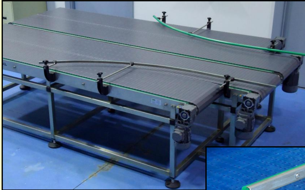
4 líneas con velocidades independientes para girado y alineado de cajas
