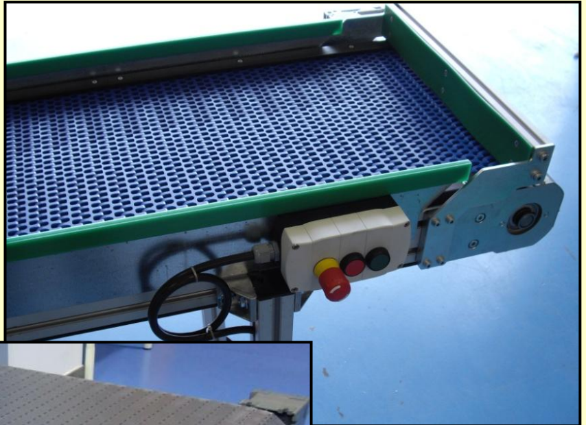
Banda Curva de 90° con guías laterales y tope final
