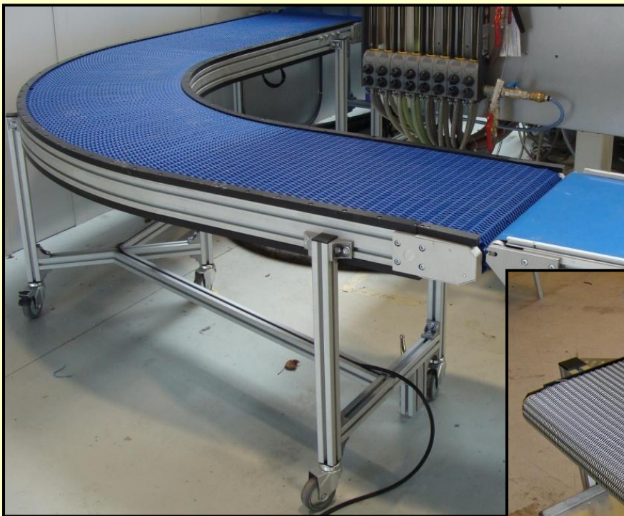
Curva de 90º con ancho de 450 mm. Soporte con ruedas
