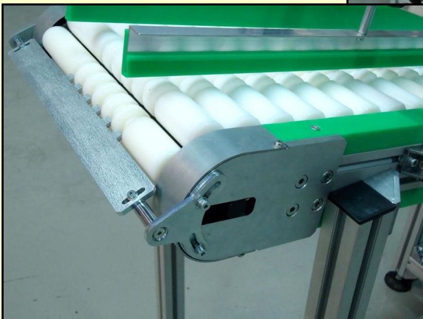
Transportador de cadenas con roldanas. Peine de caída ajustable en ángulo
