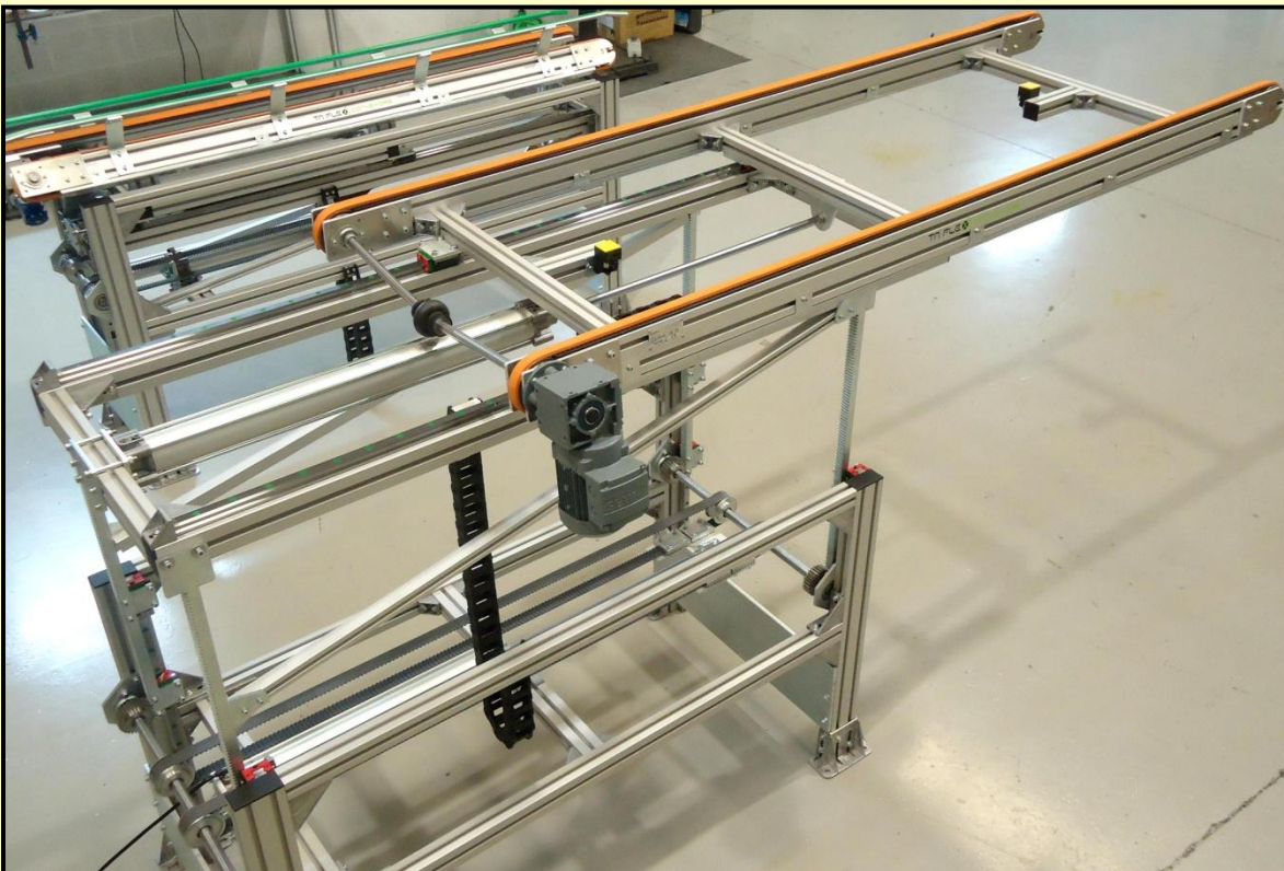
Transportador de correas dentadas con mecanismo de elevación y de avance de accionamiento neumático
