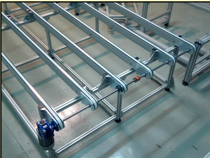
Transportador de correas dentadas con 5 hileras
