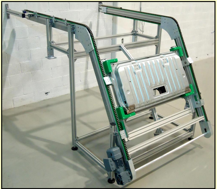
Transportador de cadenas con inflexión y carro móvil articulado. Apoyos porta-pieza copiados.
