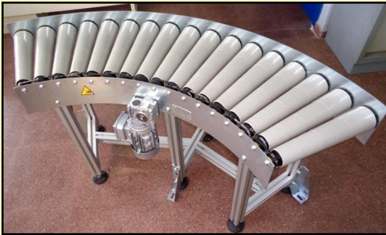
Curva de 90º mediante rodillos cónicos accionados mediante Poli-V
