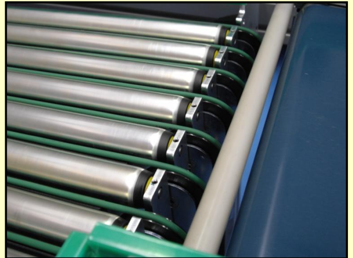
Transferencia lateral con elevación neumática
