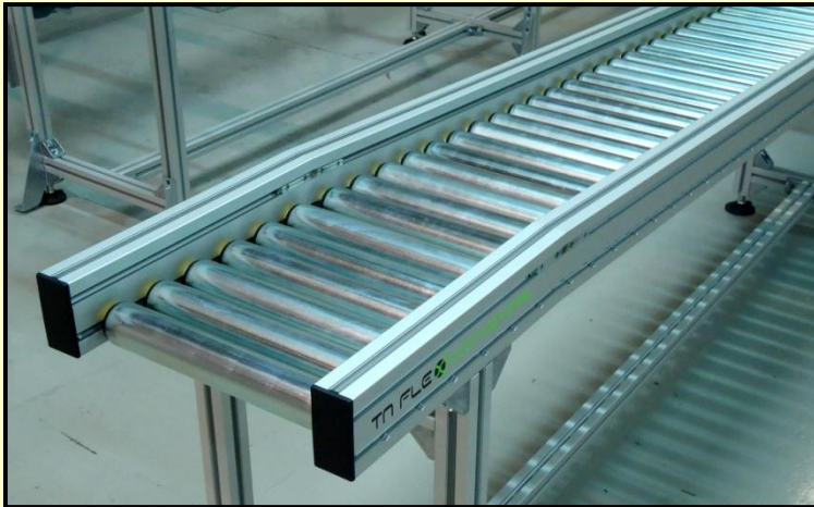
Transportador de rodillos de gravedad con inflexión y paso reducido
