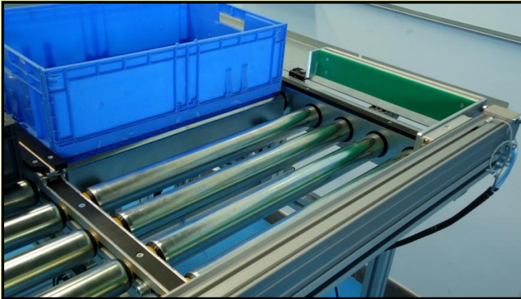
Transferencia lateral mediante cilindro sin vástago
