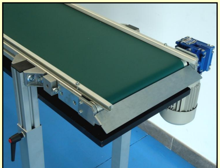
Apoyos telescópicos y rampa de caída de piezas
