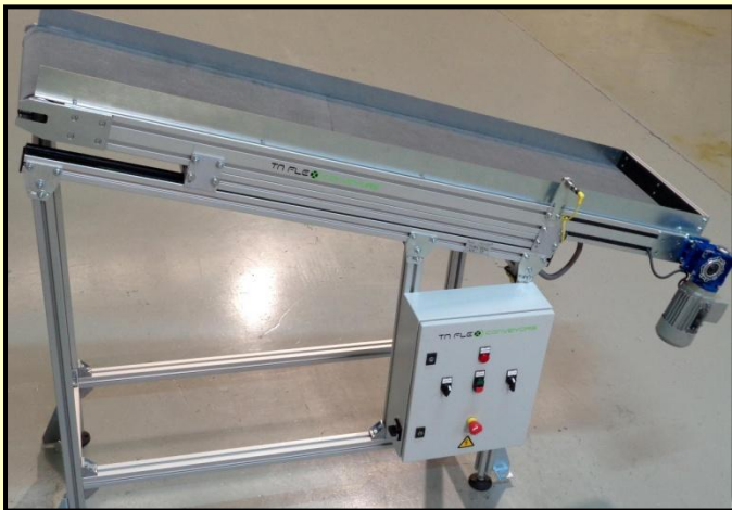
Transportador con avance neumático para carga automática de granalladora
