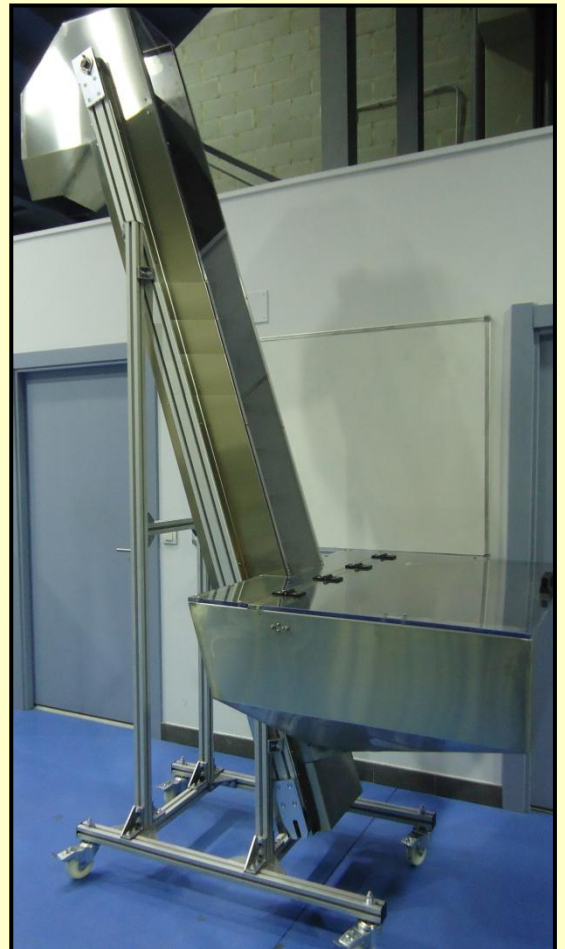
Tolva de carga, cubierta y pico de descarga en Policarbonato y acero Inox.
