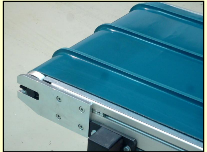
Banda con perfiles longitudinales termosoldados
