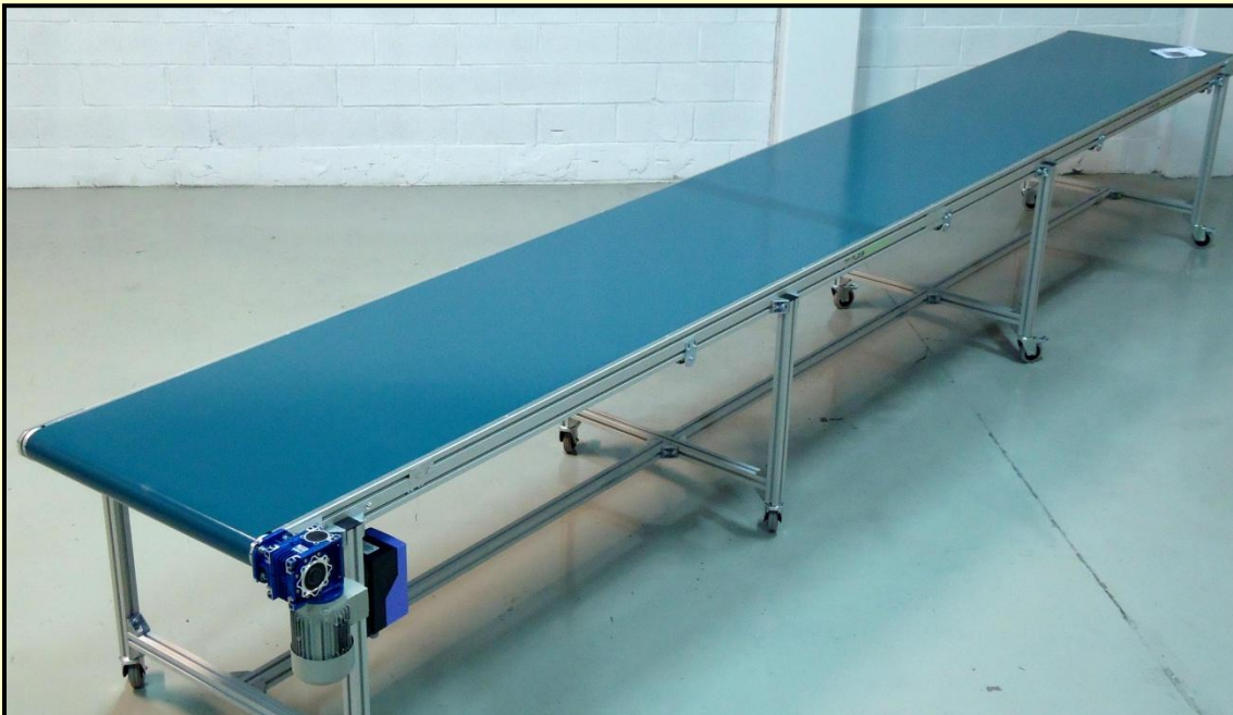
Construcción ligera con ruedas y variador de velocidad
